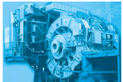
36 MW 舰船直驱永磁推进电机
