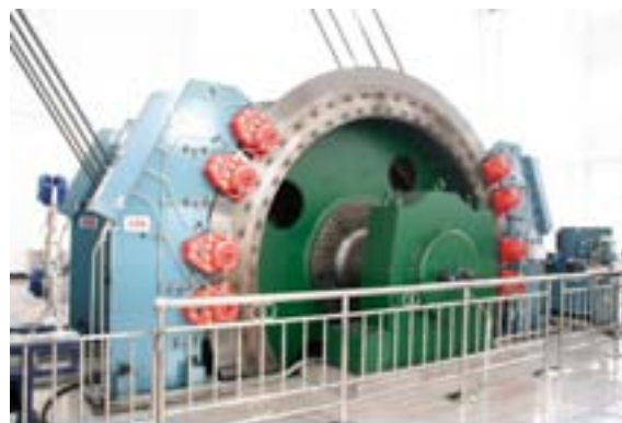
图 5-1 主机+ABB 恒减速闸控
