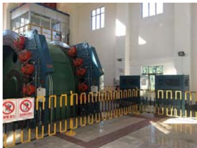
图 7-1 主机+恒减速闸控系统（双站+1 套闸控）
