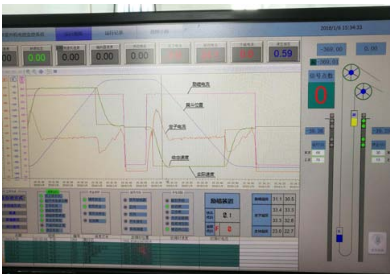
图 2-11 实际运行速度图（全载全速）
