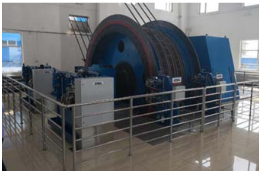
图 1-1 主机+恒减速制动系统（双站+1 套闸控）
