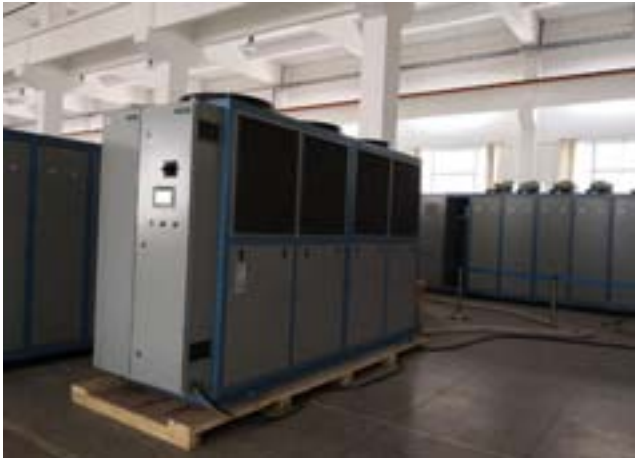
图 4-2 变频器外水冷机组（高原精密型）
