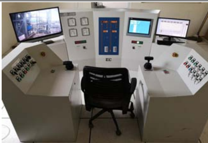
图 8-2 CZT409 扇形组合式操作台+上位监控
