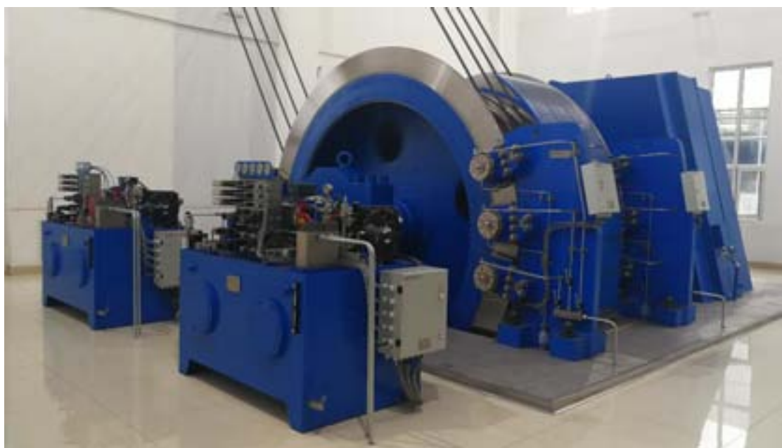
图 2-1 主机+恒减速制动系统（双站+2 套闸控）
